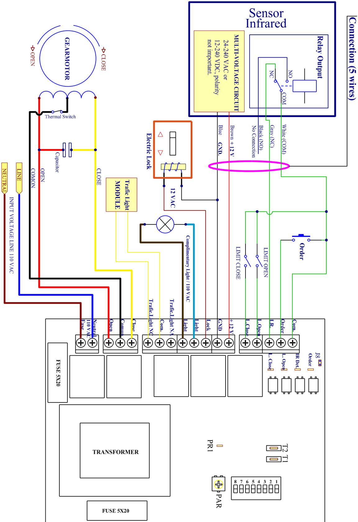
FIG Nº 2: Complete Electric Diagram
